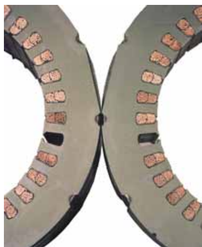
Sezione di statori con evidenza della penetrazione della resina
