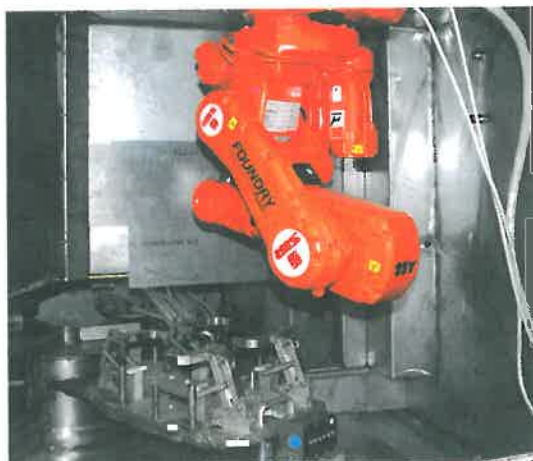
15 – Un robot antropomorfo di lavaggio posizionato.
