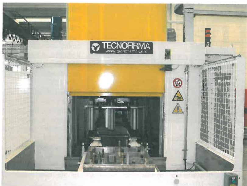
5 – Particolare della zona di carico dei pezzi su carrelli calibrati.
