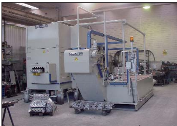
Impianto di lavaggio a trasferta
