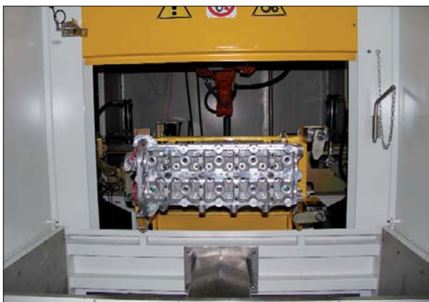
Impianto di lavaggio a moduli
