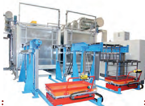
Camelot 定子U型热浸线
