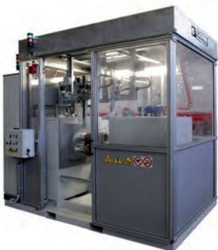
• Impregnation line for small productions • Imprägnierlinie für kleine Stückzahlen
