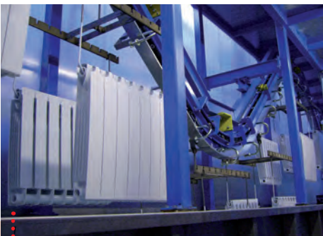
• Anaphoresis line for aluminium radiators • Anaphorese Linie für Aluminium Heizkörper
