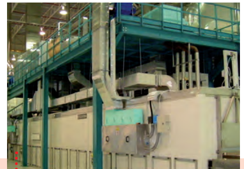
• Basecoating line for reflectors of automotive headlights • Grundbeschichtung Linie für Reflektoren in Scheinwerfer Systemen für Automotive
