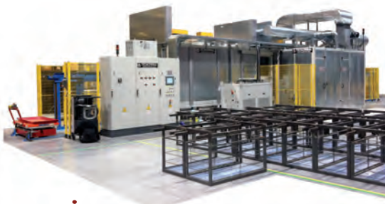
• Hot dipping impregnation line • Heiß-Tauch Imprägnier Anlagen
