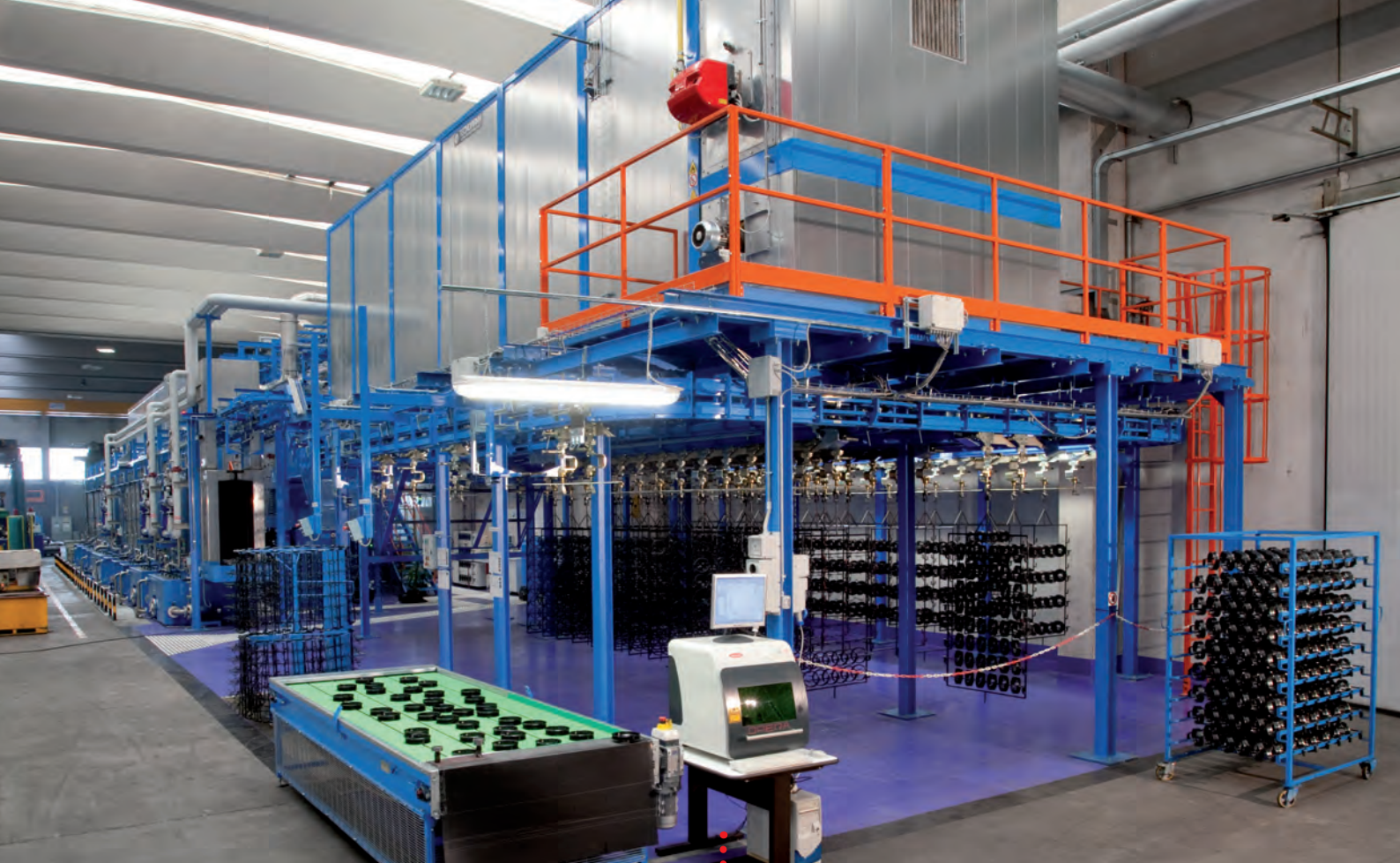
• Cataphoresis line for automotive components • Kataphorese Beschichtung Linie für Automotive Komponenten
