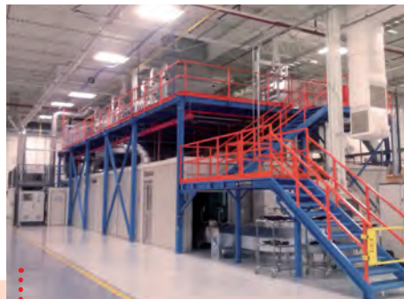
• Hardcoating line for polycarbonate lenses of automotive headlights • Oberflächenbeschichtung Linie für Polykarbonate Linsen für Automotive
