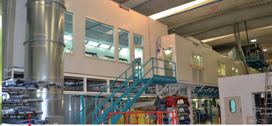
• Liquid painting line for automotive bumpers • Nass Lackierlinie für Stoßstangen in der Automotive-Industrie
