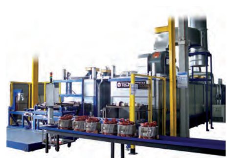
• U-type special impregnation line • U-Concept Linie Imprägnieranlage
