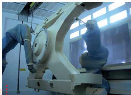
• Liquid painting line by robots • Impianto di verniciatura a liquido robotizzato
