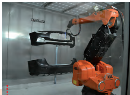
• Liquid painting line for plastic components • Impianto di verniciatura a liquido per particolari in plastica
