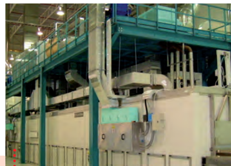
• Basecoating line for reflectors of automotive headlights • Impianto di verniciatura per riflettori di gruppi ottici auto
