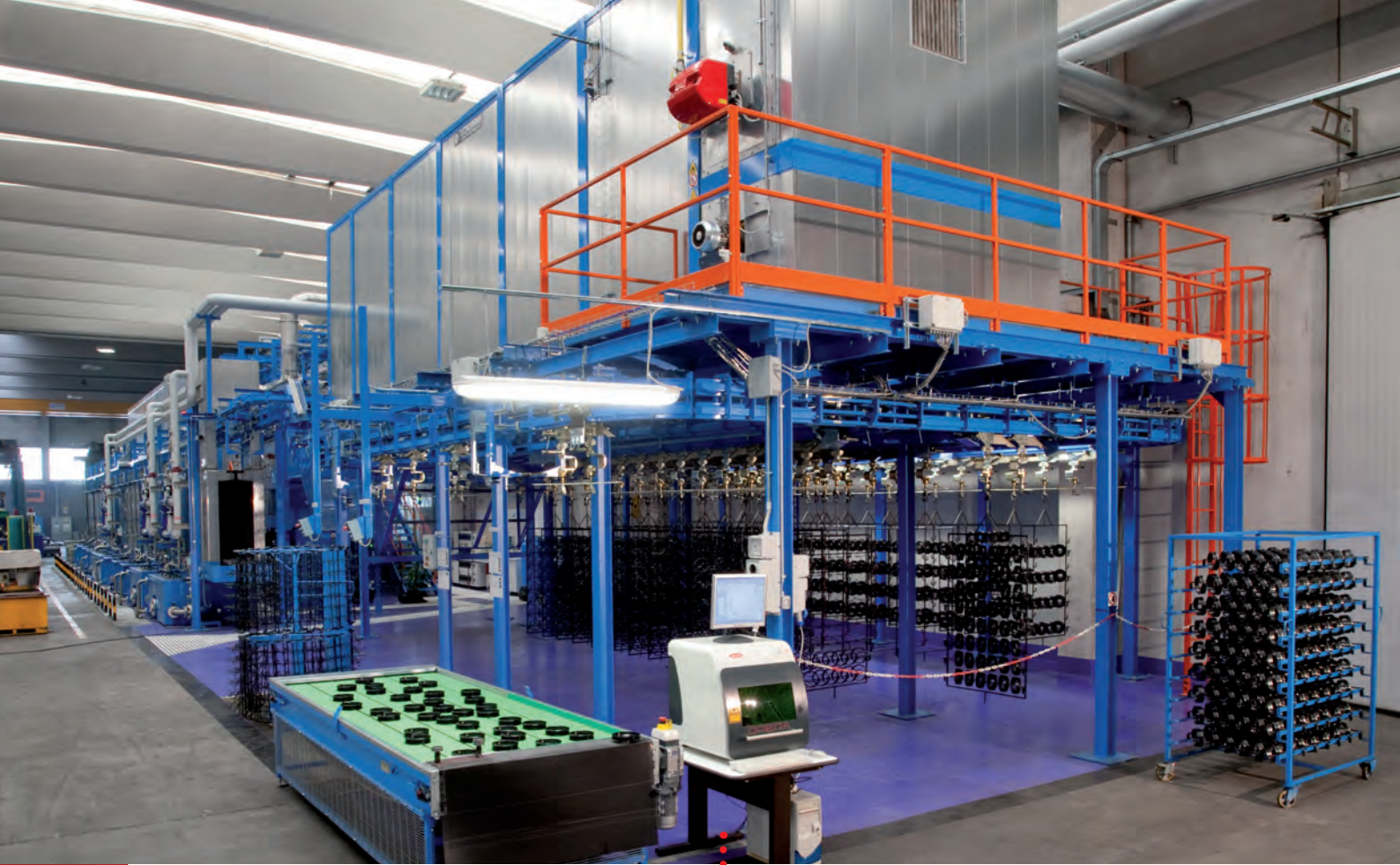
• Cataphoresis line for automotive components • Impianto di cataforesi per componenti auto
