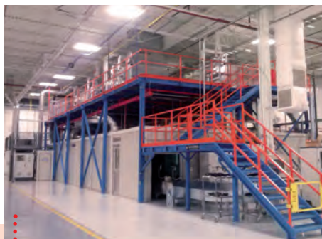
• Hardcoating line for polycarbonate lenses of automotive headlights • Impianto di verniciatura per lenti in policarbonato di gruppi ottici auto
