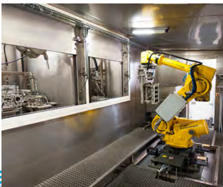
Macchina robotizzata per blocchi motore
