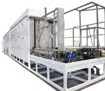
Tunnel a ricircolo di pallet per scatole batteria
