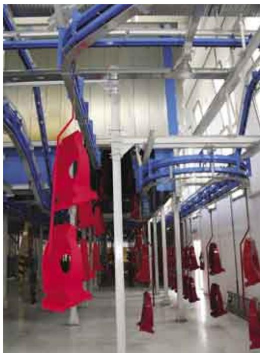
inviati al forno a campana (fig. 18) per la polimerizzazione dello strato di polvere, (fig. 19), nella cui parte inferiore si ricorda che è posizionata l'area d'impolmonamento necessaria per continuità di lavoro in linea nella pausa di mezzogiorno e alla fine del turno di lavoro.
