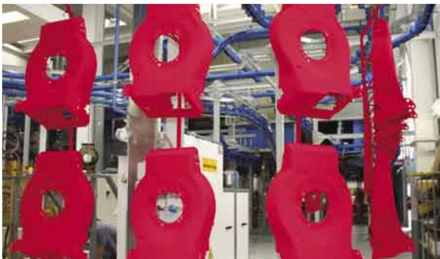
Fig. 17 - Particolare della erogazione polveri in cabina di verniciatura.
