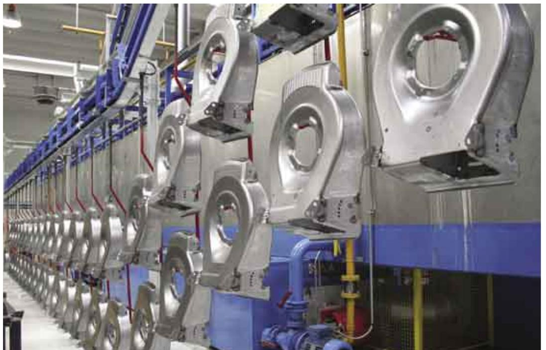
Fig. 7 - I pezzi verso il tunnel di pretrattamento nanotecnologico.
