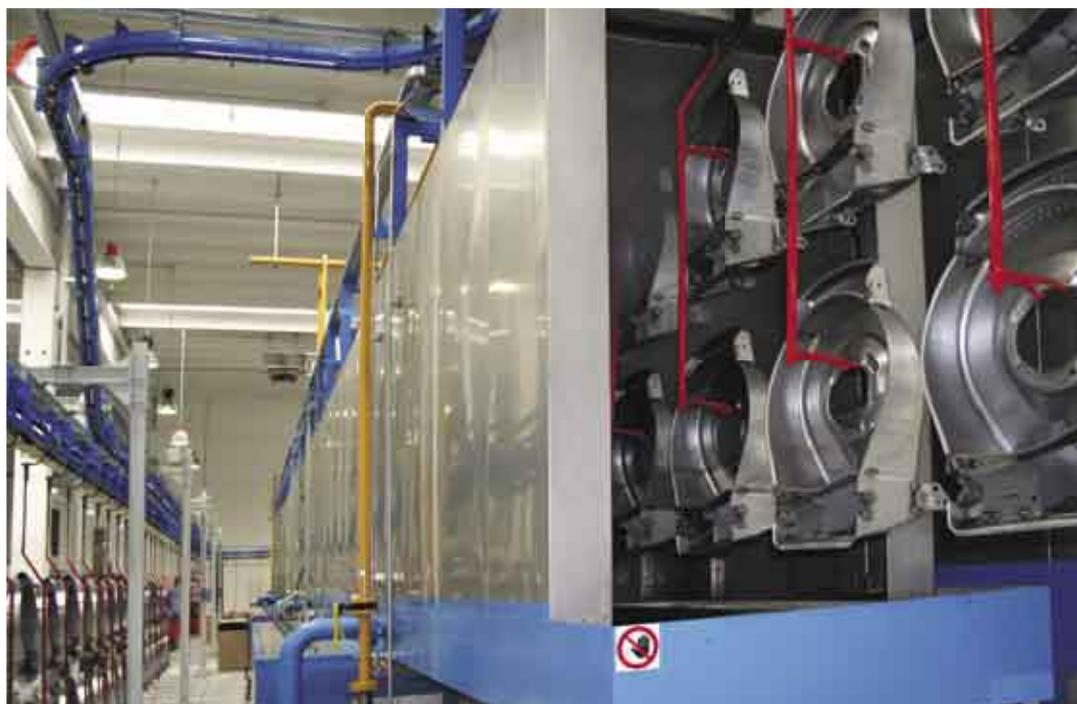
Fig. 8 - Dal carico al tunnel di pretrattamento di conversione con la Bonderite NT1.
