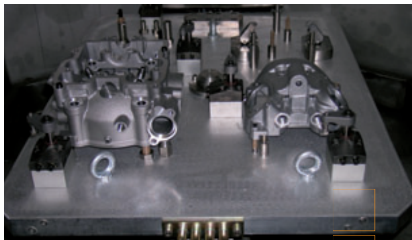
Pallet con particolari da trattare montati con sistema di bloccaggio pezzi automatico.
