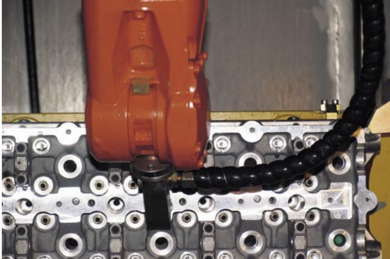
Lavaggio robotizzato Tecnofirma ad alta pressione per teste cilindro
