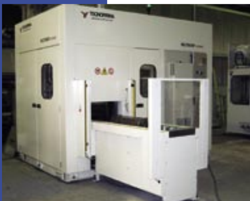
Multiwash Extreme, grazie all'aumento delle pressioni e delle portate in gioco, rende più efficace il lavaggio idrocinetico
