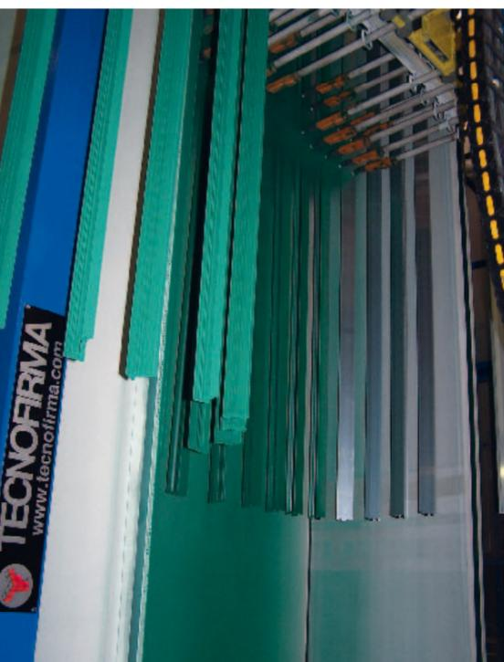
Tecnofirma ha sviluppato una linea di impianti dedicata al pretrattamento e verniciatura a polvere di profilati estrusi in alluminio con disposizione verticale
