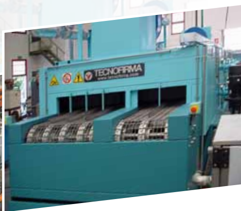
Una fase di fosfatazione del compressore e il particolare di un impianto di cataforesi per corpi compressori. Una lavatrice a tunnel con nastro greccato per coperchi e scatole compressori.
