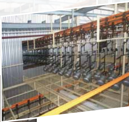
Una fase di fosfatazione del compressore e il particolare di un impianto di cataforesi per corpi compressori. Una lavatrice a tunnel con nastro greccato per coperchi e scatole compressori.
