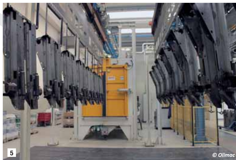
5 The storage buffer before the entry of parts in the shot blasting machine. Il polmone di accumulo prima dell'entrata dei manufatti nella granigliatrice.
