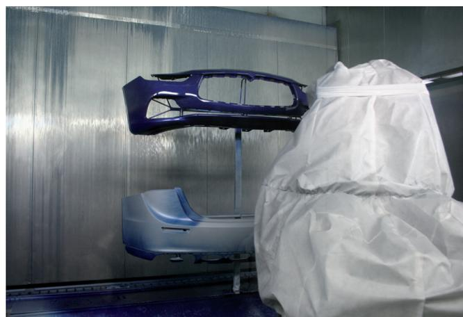
8 e 8a – La cabina di applicazione della base colorata e della finitura trasparente, è dotata di 2 robot ed è parte dell'impianto originario.
