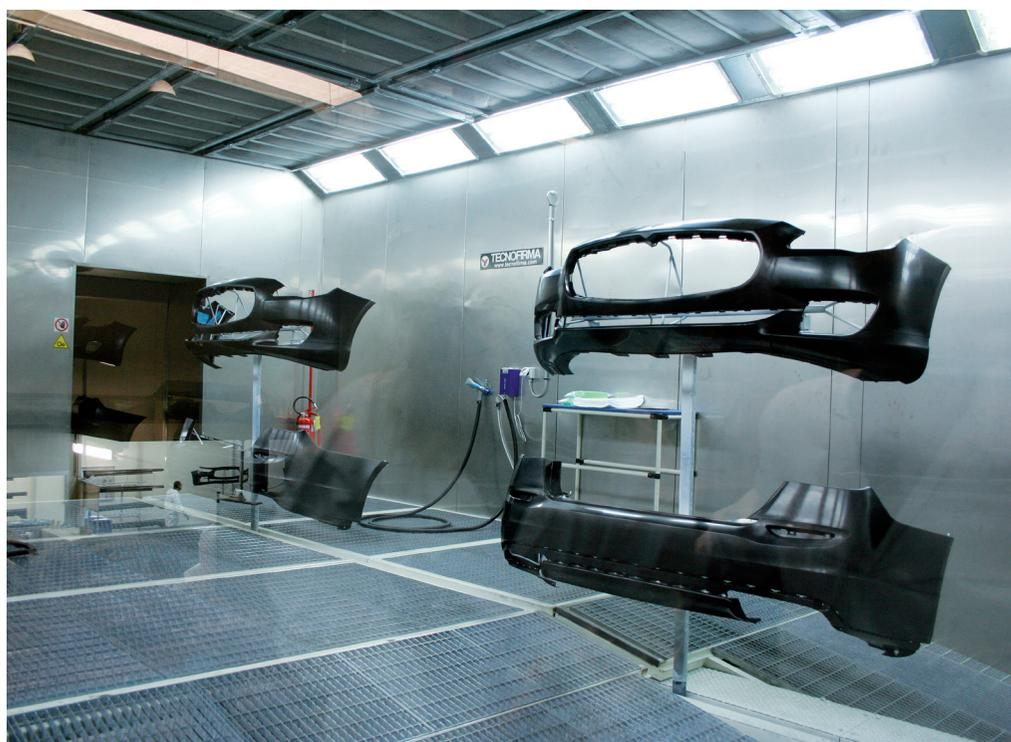
5 – La cabina di lavaggio innovativa: si basa su un nuovo concetto, a secco, effettuato da una pre-pulizia manuale con una sostanza alcolica e dall'utilizzo di un getto d'aria controllato.
