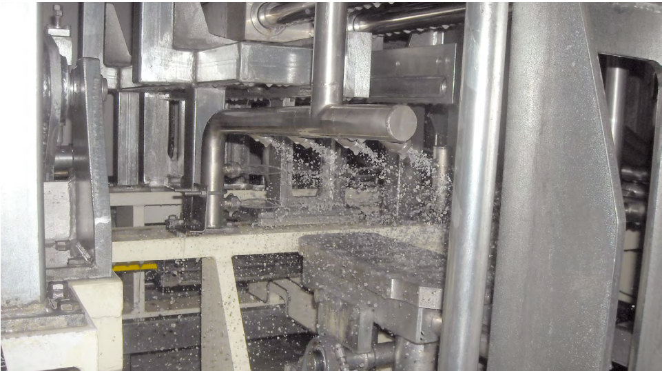
3 – Una fase del processo di lavaggio di un blocco cilindri. Una fase del proceso de lavado de un bloque de cilindros.
