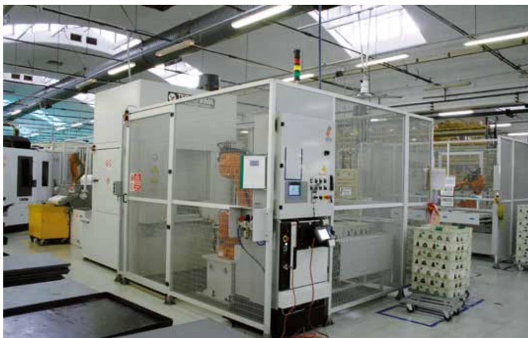
duzione un concetto di lavaggio “flessibile”, a isole, dove si utilizza almeno un robot che riesce ad operare anche nelle zone meno accessibili dei pezzi, togliendo bave e residui della lavorazione meccanica».
