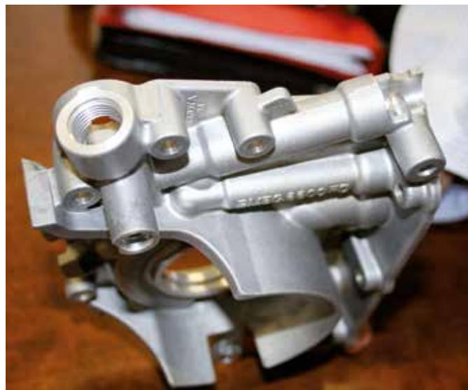
7, 8 – I pezzi delle pompe a olio prodotte da Pierburg. Si noti la complessità della sezione, costituita da canali di limitata dimensione che si intersecano tra di loro.
