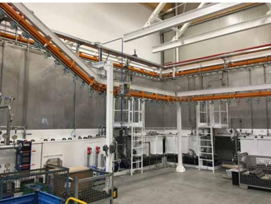
**Tunnel di pretrattamento ad angolo con processo nanotecnologico.**
