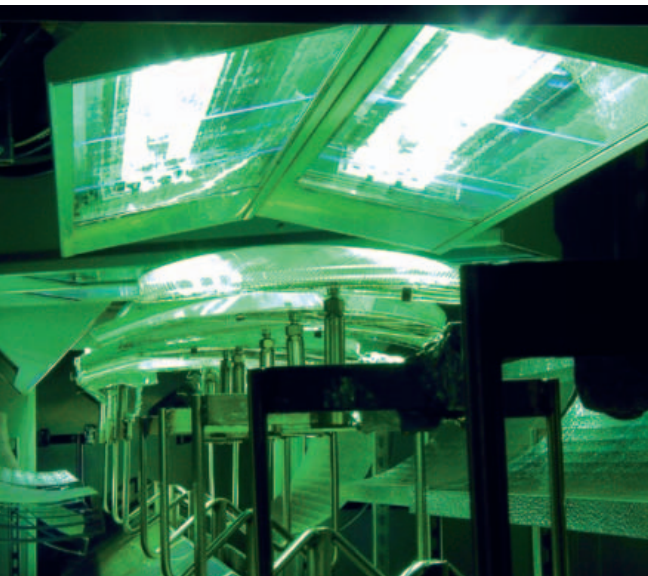
Un particolare di un impianto di verniciatura delle lenti e un impianto di lavaggio entrambi costruiti da Tecnofirma.
