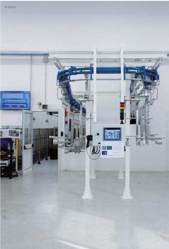
**L'area di carico dei pezzi sul trasportatore aereo che asserve l'impianto di pretrattamento.**
