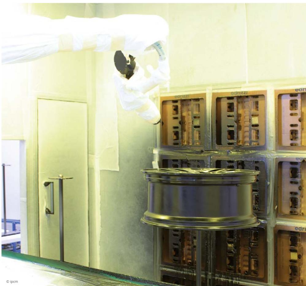
**L’unità di controllo dei robot CMA Robotics all’esterno delle cabine e l’interno della cabina per l’applicazione del topcoat con filtri edrizzi.**
