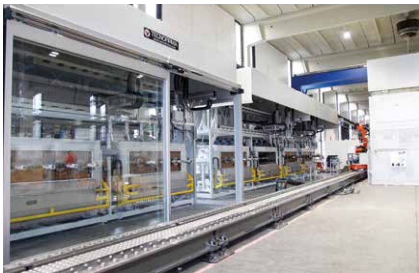
In alto: singola unità modulare, base di partenza per lo sviluppo di linee ad alta cadenza produttiva. Sopra: la vista laterale della linea modulare per alte cadenze produttive, sono raffigurati più moduli posizionati in parallelo e il forno di preriscaldamento e cottura. Nella pagina accanto, un'operazione di carico della linea attraverso robot a 7 assi su slitta motorizzata.
