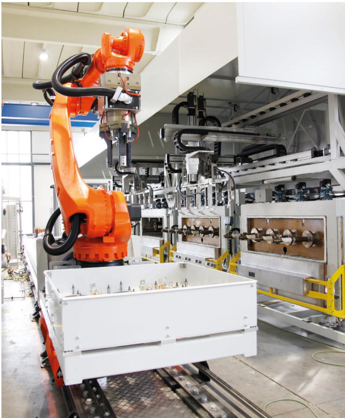
**3 – Tecnofirma progetta, fabbrica e installa impianti completamente automatici, modulari, per l'impregnazione ad alta cadenza di statori con avvolgimenti sia tradizionali sia hairpin.**
