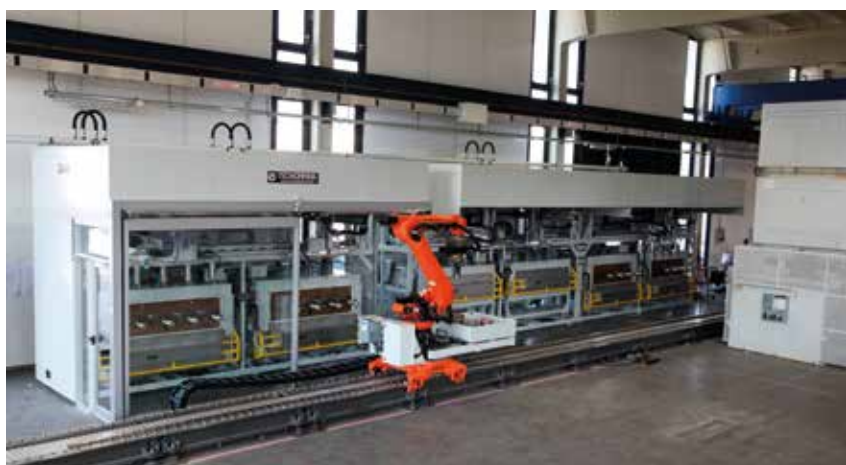
Un impianto di verniciatura a liquido per telai di macchine escavatrici e una macchina di impregnazione modulare per motori elettrici automotive. Nella pagina accanto, un impianto di lavaggio robotizzato per basamenti e teste di motori.
