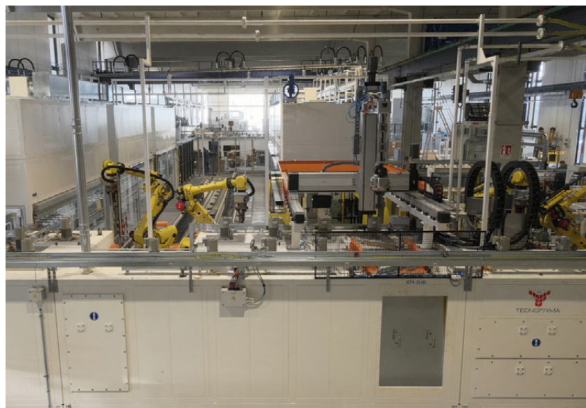
La vista generale dell'impianto e quella dell'impianto su forno e pick & place per verniciatura a polvere. Nella pagina accanto, l'area di carico
