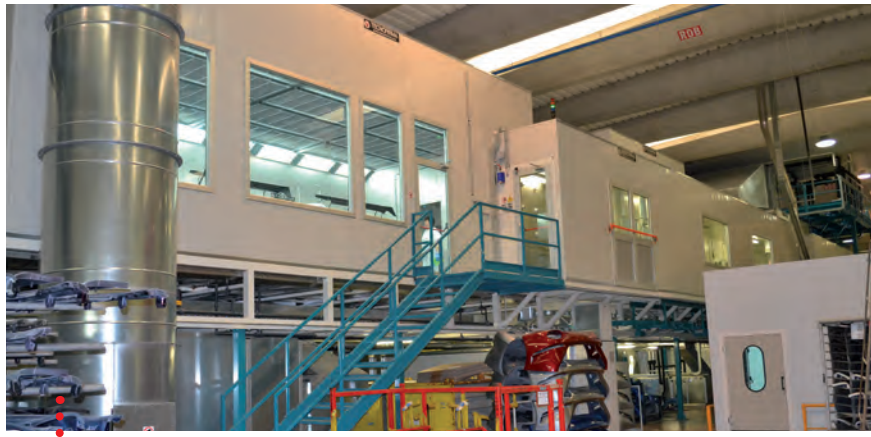
Liquid painting line for automotive bumpers Nass Lackierlinie für Stoßstangen in der Automotive-Industrie
