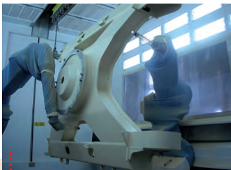
Liquid painting line by robots Nass-Lackier Linien mit Roboter
