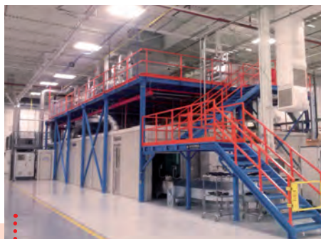
Hardcoating line for polycarbonate lenses of automotive headlights Oberflächenbeschichtung Linie für Polycarbonate Linsen für Automotive
