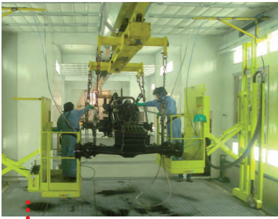
Liquid painting line for body tractor Nass Lackierlinie für Karosserie von Landwirtschaftlichen Fahrzeugen
