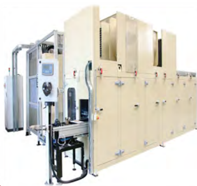
Ring impregnation line for high productions Imprägnierlinie für Serienfertigung
