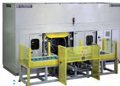
• Hydrokinetic washing plant for big parts • Flutinjektion Anlagen für Massive Bauteile
